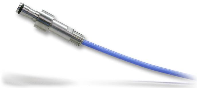
Die bündig eingebaute piezoelektrische 4 mm KavitätDruck Sensor 6157 von RJG, Inc. ist ein ein- oder mehrkanaliger Sensor, der standhältKräfte von bis zu 29.008 psi (2.000 bar) und einer maximalen Temperatur von 392 °F (200 °C).
