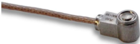
Der 9210 ist ein ein- oder mehrkanaliger, indirekter (unter dem Stift) 3,5 mm (0.14") knopfartiger piezoelektrischer Hohlraumdruck Sensor zur Verwendung mit RJG, Inc. eD-ART® oder CoPilot® Prozesssteuerungs- und Überwachungssystemen.
