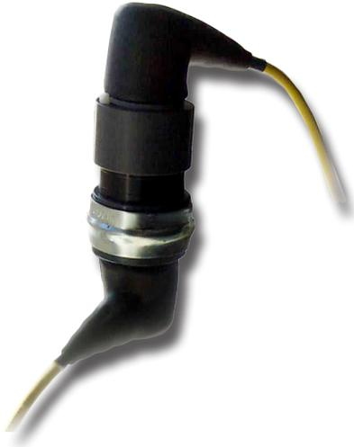
Der Lynx™ -Schleifringverbinder C-LX-SR-2M-M90 ermöglicht den Anschluss von Lynx-Sensoren, die auf Drehtischformen montiert sind, an das eDART oder-CoPilot System von RJG, Inc.. Der C-LX-SR-2M-M90 wird direkt auf dem Drehtisch montiert und ermöglicht eine volle Drehung von 360 Grad zwischen den Lynx-Verbindungen.
