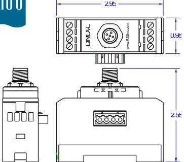
DIN/LX-D ist ein Lynx zu DIN-Schienen Kommunikationsmodul, das als Interface zwischen standardmäßigen Lynx-Kabeln und auf Lynx DIN-Schienen montierten Modulen dient, falls kein ID7-D-SEQ verwendet wird. DIN/LX-D ist zum Einsatz mit dem eDART® System vorgesehen.
