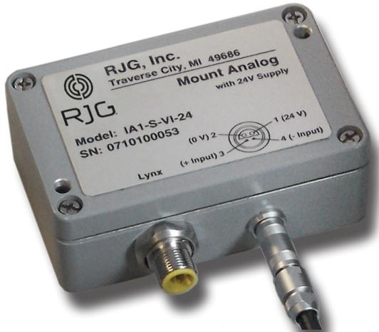
Das oberflächenmontierte analoge Eingangsmodul IA1-S-VI-24 von Lynx™ ist ein oberflächenmontiertes Modul, das mit der Spritzgießmaschine verdrahtet wird, um 0–10-V-Gleichstrom- oder 4–20-mA-Signale von analogen Messgeräten zu erfassen und Informationen wie Einspritzdruck, Kunststoffdruck, Schraubenposition oder Temperatur. Dieses Modul kann einige Sensoren mit einer 24-V-Stromquelle versorgen und ist abgeschirmt, um auch in rauen Spritzgussumgebungen eine hohe Datenqualität zu gewährleisten.
