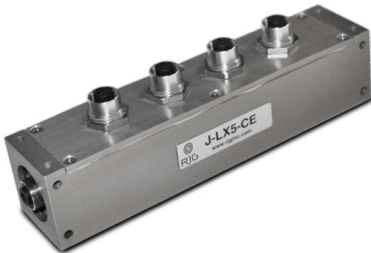
Der Lync™ Fünf-Port-Anschluss J-LX5-CE bietet Anschluss und Stromversorgung für bis zu fünf Lync-Geräte an die eDART®- oder CoPilot®-Systeme über eine einzige Verbindung und kann an der Maschine oder am Werkzeug montiert werden, auch in Bewegung oder stationär Platten oder Formhälften.
