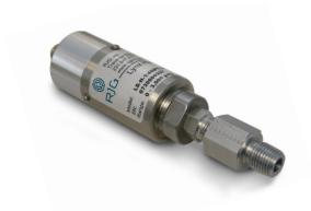
Der Lynx $^{\rm M}$  3,000/5,000 psi HydraulikDruck Sensor LS-H-1/4NPT-3K/5K wird am Hydrauliksystem von Spritzgießmaschinen installiert, um das eDART $^{\rm @}$ - oder CoPilot $^{\rm @}$ -System mit Einspritzung zu versorgen und Gegendruck Daten.
