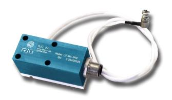
Der Formdurchbiegungssensor LS-MD-040 von Lynx misst zur Verwendung mit dem eDART $^{\otimes}$ -System bis zu 0.040 $^{\circ}$  (1,016 mm) Formdurchbiegung an der Trennlinie in jedem Zyklus.
