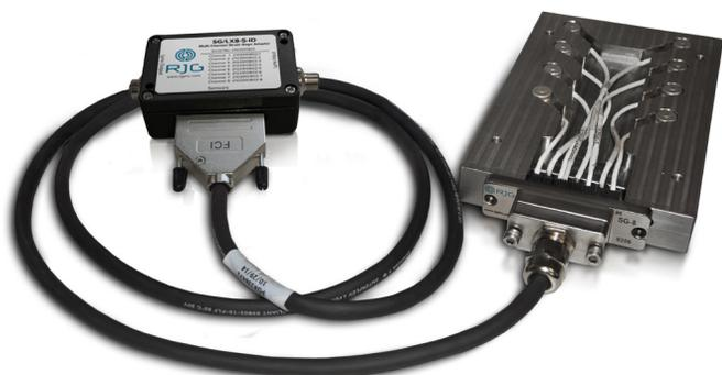
RJG, Inc. bietet eine breite Palette von Hohlraumdrucksensoren für jede Anwendung - Dehnungsmessstreifen, einkanalig, mehrkanalig und digital.
