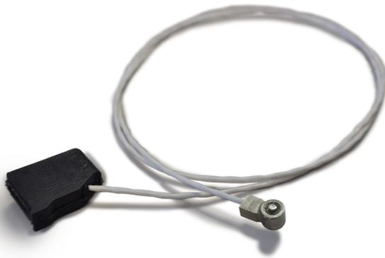
Der MCSG-B-60-50/250 ist ein mehrkanaliger, digitaler Dehnungsmessstreifen, indirekt (unter Stift), 6 mm (0,236 Zoll) Hohlräumdrucksensor im Knopfstil, der für die Verwendung mit dem RJG eDART®- oder CoPilot®-Prozess entwickelt wurde Steuerungs- und Überwachungssystem.
