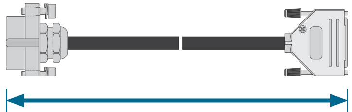
Sensorplatte-zu-Sensor-Adapterkabel C-SG/LX8-S Länge
