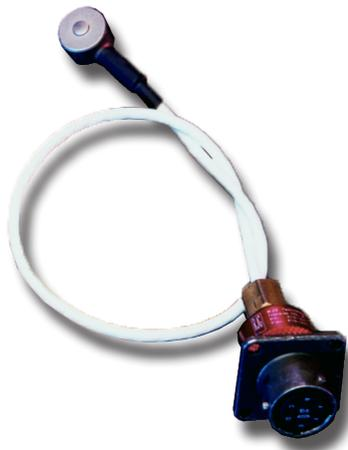
Die analogen Einkanal-DMS-Sensoren T-414-12, T-412-12 und T-413-12 von Lynx™ sind indirekte (unter Stift), 0,50 Zoll (12,7 mm) knopfförmige Hohlraumdrucksensoren, mit gelötetem Schaft am Gehäuse und zugentlastetem Stecker.
