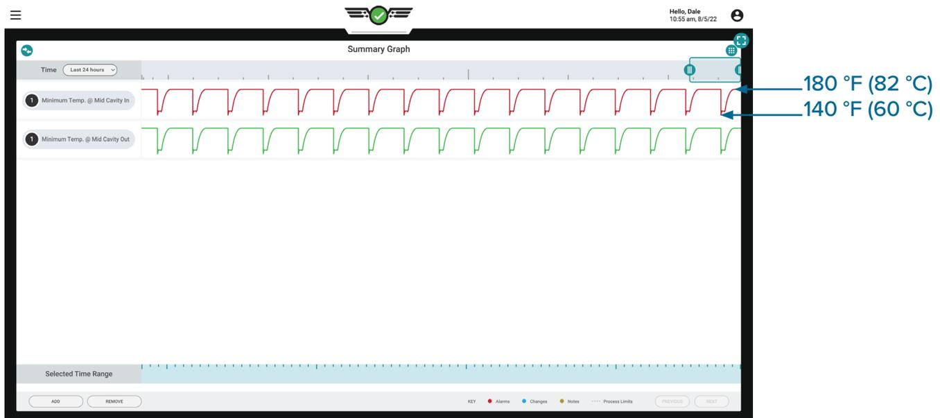
Die Zeit bis zum Erreichen der Stabilität dauert oft länger als erwartet. Daher ist das Konzept der Ermittlung der Formtemperaturstabilität wichtig, wenn ein Prozess für den „Lights-Out“-Betrieb vorbereitet wird oder bevor Teile zur Messung beprobt werden.
